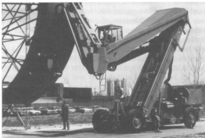
Fig. 9 Robô limpador de casco de navios que utiliza sensor de proximidade indutivo para manter uma ferramenta de limpeza a uma curta distância do casco do navio.
